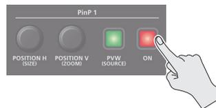
Die Anzeige des PinP 1 [ON]-Tasters leuchtet rot, das Kleinbild wird auf das Hintergrundvideo gesetzt und das Gesamtergebnis ausgegeben.
