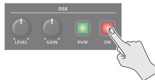
Die Anzeige des DSK [ON]-Tasters leuchtet rot und das zusammengestellte Bild wird final ausgegeben.
