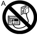
Verbinden Sie den Stromerzeuger nicht mit der Hausinstallation oder dem öffentlichen Stromnets.
