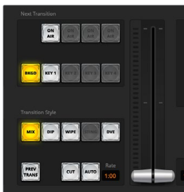
Contrôle des transitions
