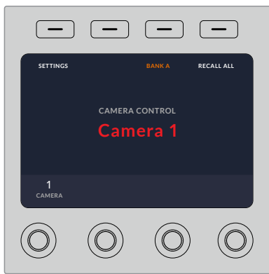
LCD 홈 스크린 위에 표시된 카메라 이름과 번호는 각 CCU에 지정된 카메라를 나타냅니다.
