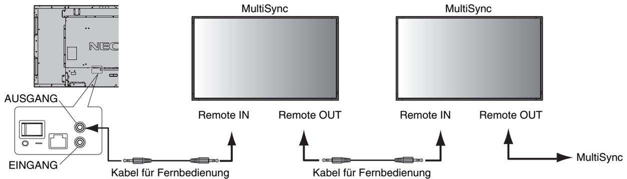
**HINWEIS:** Schalten Sie den Hauptschalter aus, bevor Sie den Stereo-Miniklinkenstecker anschließen/trennen.
