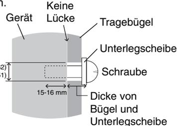
Die Schraubenlänge sollte mit der Tiefe der Bohrung (15-16 mm) und der Stärke des Tragebügels und Unterlegscheibe übereinstimmen. Bügelaussparung sollte weniger als  $\phi$  8,5 mm (V422/V462),  $\phi$  10,0 mm (V651) betragen.
