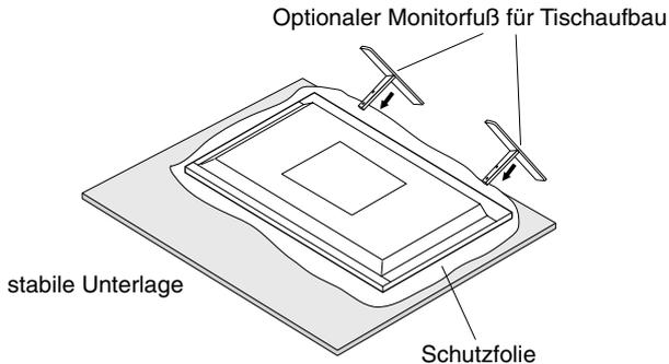
**HINWEIS:** Montieren Sie den Fuß beim V422/V462 so, dass die langen Enden der Standflächen nach vorne zeigen. Montieren Sie den Fuß beim V651 in Richtung der auf der Oberfläche des Fußes eingepprägten Pfeilmarkierung. Verwenden Sie das Modell ST-4020 für den V422, das Modell ST-4620 für den V462 und das Modell ST-651 für den V651.
