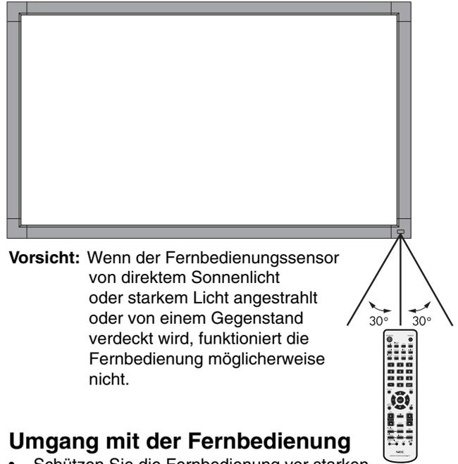
**Vorsicht:** Wenn der Fernbedienungssensor von direktem Sonnenlicht oder starkem Licht angestrahlt oder von einem Gegenstand verdeckt wird, funktioniert die Fernbedienung möglicherweise nicht.
